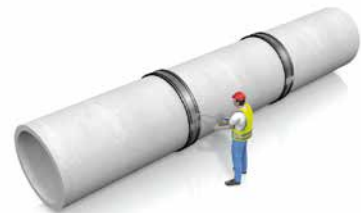
Kupplung mittig über beide Spitzenden schieben und Schösser wechselseitig anziehen.
