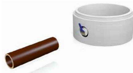
Gleitmittel auf Dichtung auftragen.
