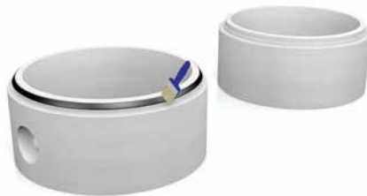
Gleitmittel auf Dichtung auftragen.
