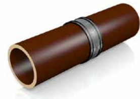
Kupplung mittig über beide Spitzenden schieben und Schlösser wechselseitig anziehen.
