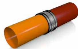
Kupplung mittig über beide Spitzenden schieben und Schlösser wechselseitig anziehen.
